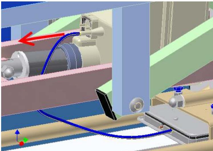
**2/ Raccorder au tube en laiton le petit bout de tuyau caoutchouc :**
