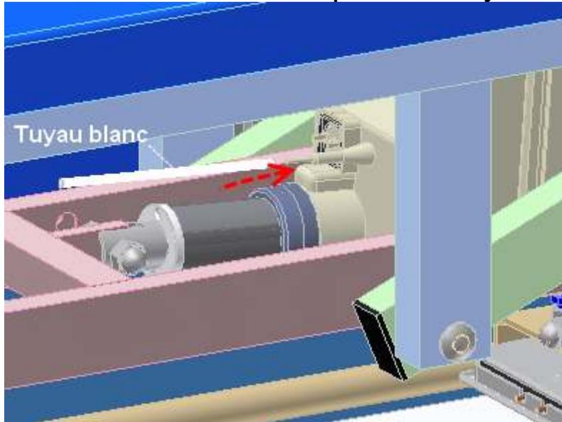
**3/ Raccorder l'extrémité de ce tuyau au Té de connexion bleu :**
